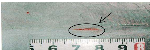
溶接部止端の割れ
