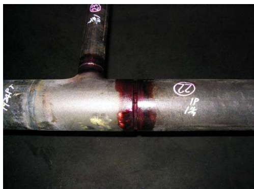
配管の初層溶接部、浸透状況
