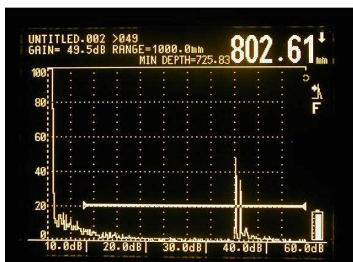
落橋防止装置のアンカーボルト長測定 (デジタル形超音波探傷装置による)
