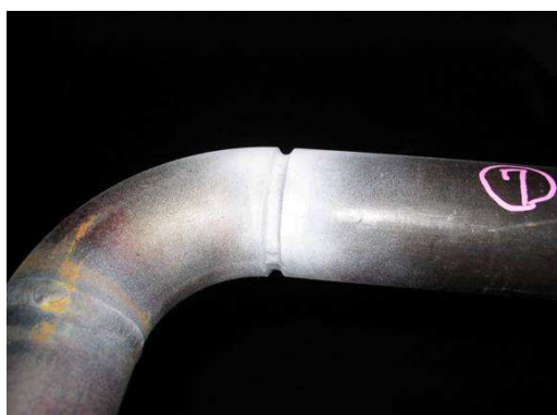
配管の初層溶接部、現像状況
