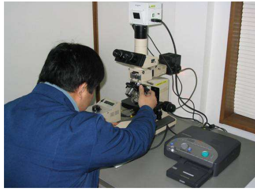
金属組織検査用光学顕微鏡による観察
