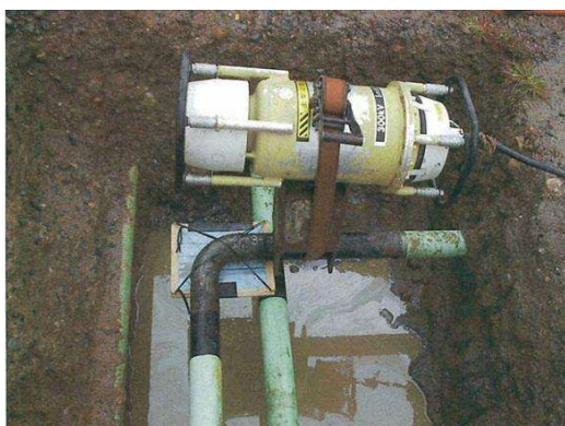
放射線透過試験による埋設配管の内部腐蝕調査
