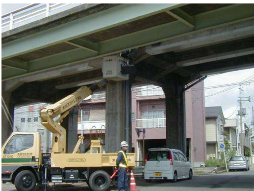
落橋防止装置のアンカーボルト長測定 (デジタル形超音波探傷装置による)
