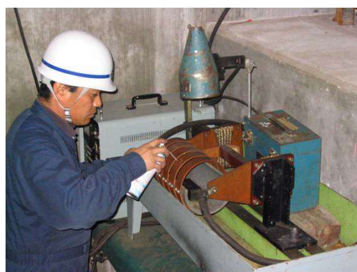
小型部品の磁粉探傷試験(コイル法)
