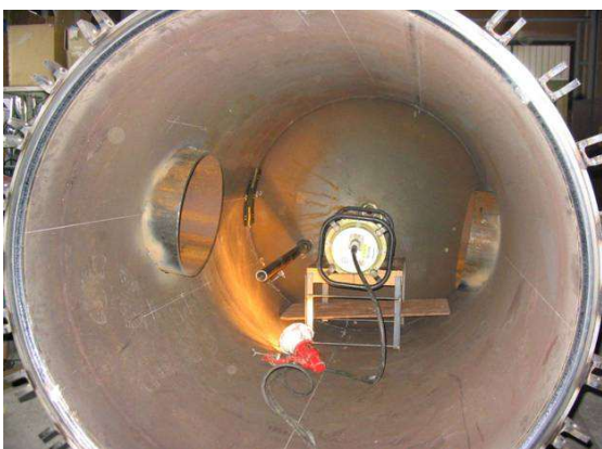
圧力容器の放射線透過試験
