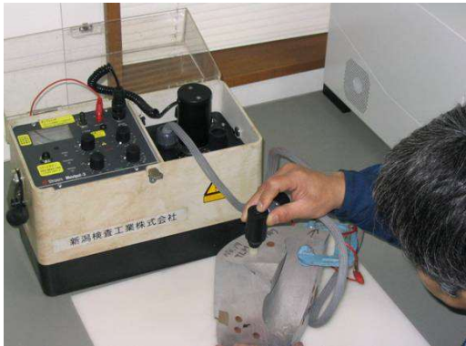
電解腐食器による電解研磨及び電解腐蝕
