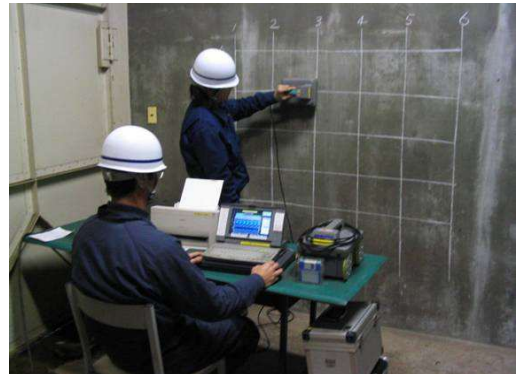
電磁波レーダによるコンクリート壁面調査
