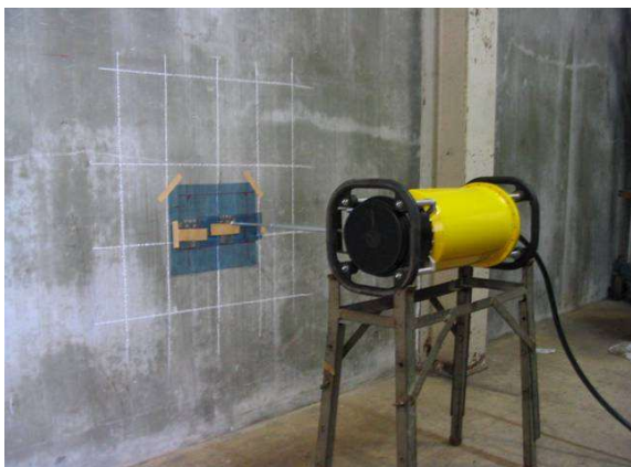
コンクリート壁面の放射線透過試験
