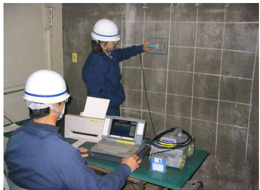
電磁波レーダによるコンクリート壁面調査
